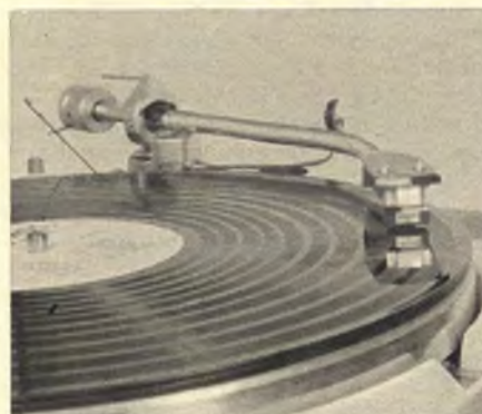
Bild 4. Skatingkraft-Detektor im Shure-SME-Tonarm bei unkompenzierter Skatingkraft
