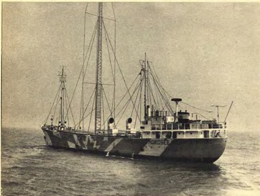
Der ehemalige Küstenfrachter wurde Mebo II genannt (Mebo I ist ein dazu gehöriges Versorgungsschiff). Das Schiff trägt jetzt vier Sender und vier Antennenanlagen. Deutlich ist die enge Nachbarschaft der einzelnen Antennen untereinander zu erkennen. Eine gegenseitige Beeinflussung ist daher praktisch nicht auszuschließen (Aufnahme: E. Jacob)
